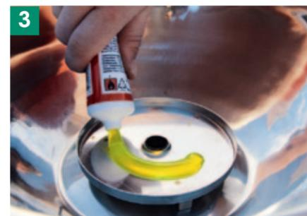
3 Auf das kleine Podest wird eine Brennpaste aufgetragen und entzündet. Die Flamme ist oft nicht sichtbar
