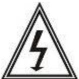
Das Blitzsymbol im Dreieck soll den Benutzer vor nicht isolierter gefährlicher Spannung innerhalb des Gerätegehäuses warnen, die elektrische Schläge hervorrufen kann.
